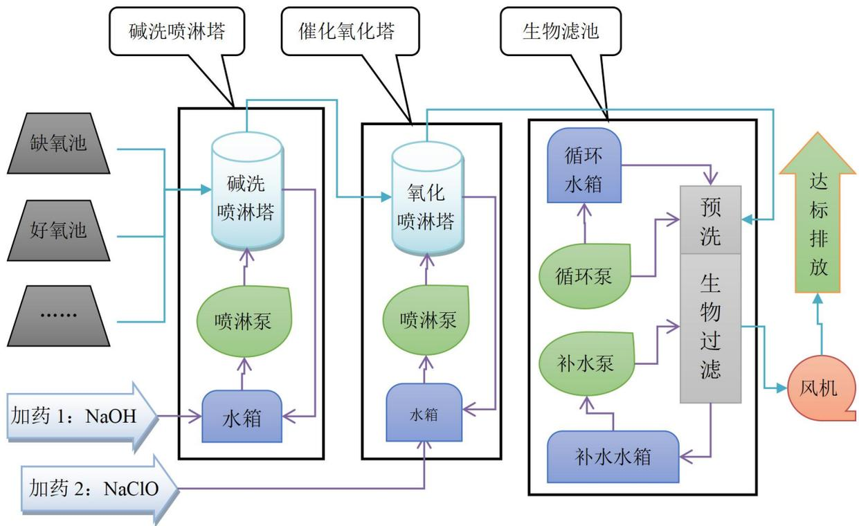
图 1 污水站臭气治理工艺流程图
