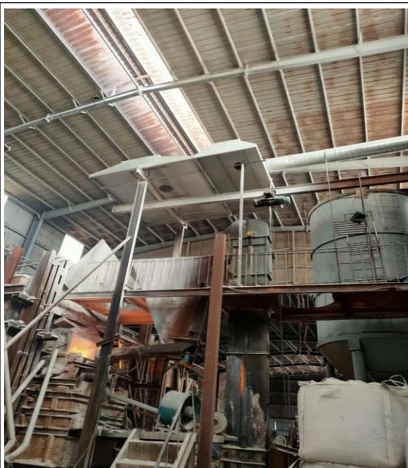
蓄热式马蹄焰熔炉进料口集气罩
