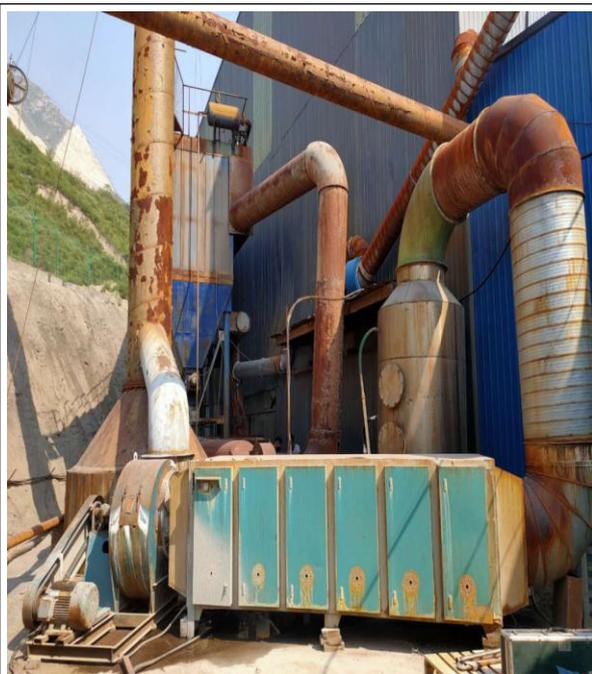
蓄热式马蹄焰熔炉布袋除尘器+喷淋塔
